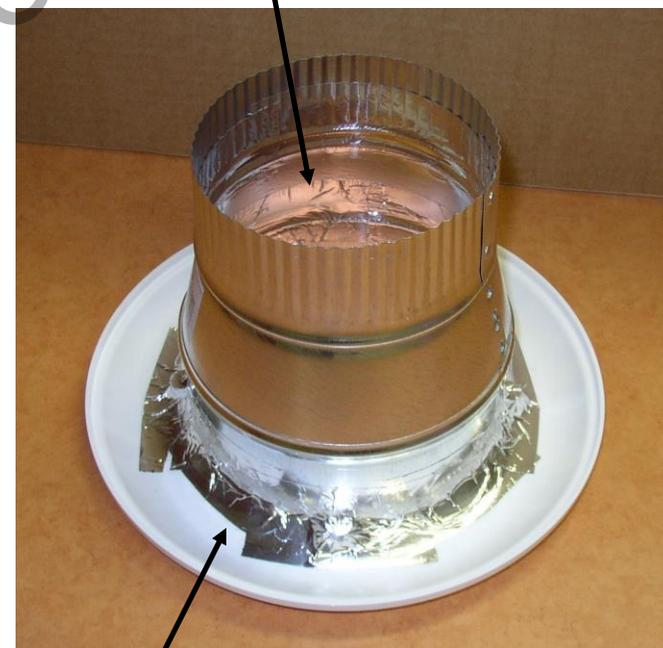
**FABRIQUER DEUX ENTONNOIRS POUR LE MESURAGE DES DÉBITS DES GRILLES DU SOUS-SOL SANS FINITION AU PLAFOND (voir feuille suivante)**
